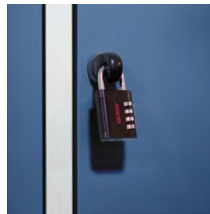
Sicherheits-Drehriegelverschluss für Vorhangschloss (dreht in verschlossenem Zustand durch und verhindert damit das Aufbrechen durch Überdrehen), inkl. Türschutz
