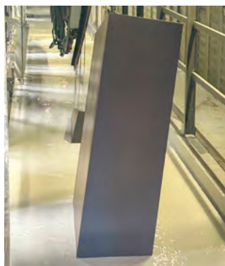
Tauchlackierung bei C+P
