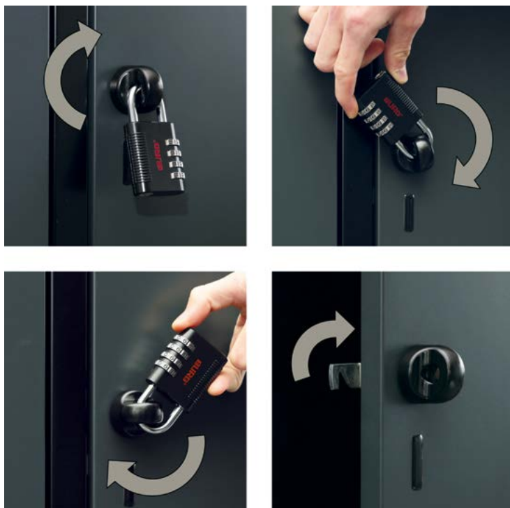
Bezpieczny zamek obrotowy C + P Obraca się, gdy jest zablokowany, a tym samym zapobiega wyłamaniu przez nadmierne przekręcenie.
